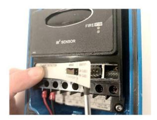
Introduzca el cable de calibración en el conector de mantenimiento, asegurándose de que el conector está enchavetado, de modo que solo encaje en un sentido.
