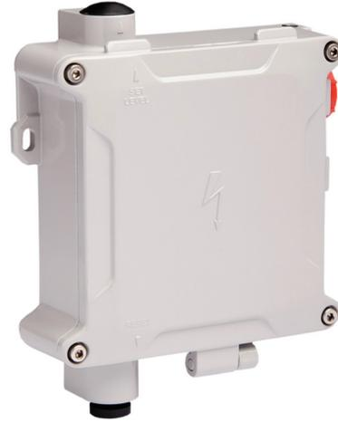
3171型振动开关是一款低成本、高灵敏度的产品，用于保护旋转和往复式运动的设备。该产品触发水平可调节，当设备振动强度超出正常运转的水平时，即可发出报警信号和/或启动停车保护电路。一旦被触发，其内部的微动开关会保持在锁闭状态，直至进行复位操作。
