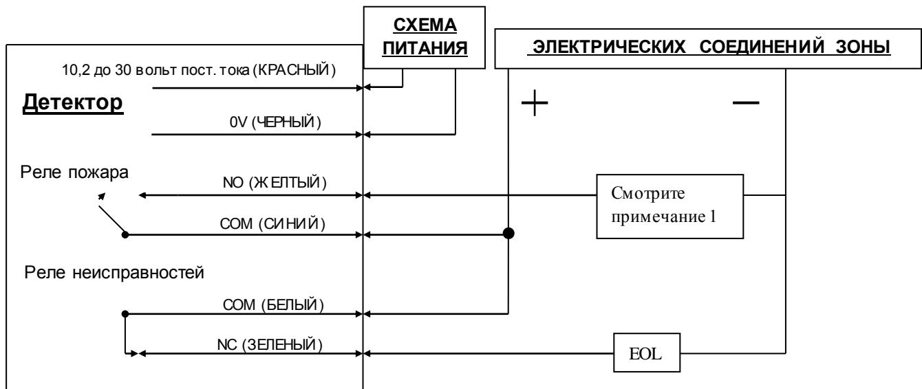
Примечание 1 – Эта деталь является сопротивлением пожара, и его значение указывает предприятие-изготовитель пульта управления детектора пожара. Для электроприборов, устанавливаемых в США, обычно таким значением является короткое замыкание.
