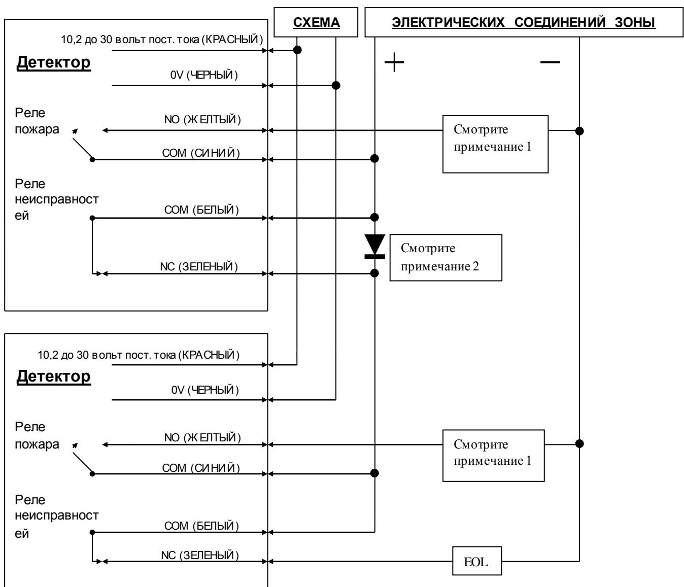
Примечание 1 – Эта деталь является сопротивлением пожара, и его значение указывает предприятие-изготовитель пульта управления детектора пожара. Для электроприборов, устанавливаемых в США, обычно таким значением является короткое замыкание.
