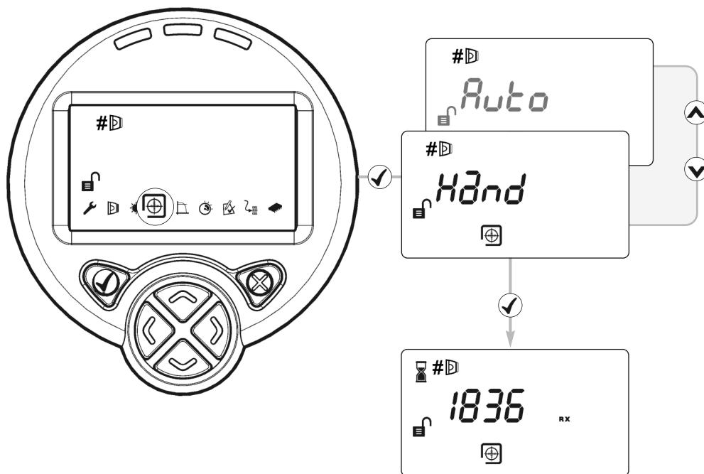
Ako se LASER ne vidi zbog okruženja u kojem je uređaj postavljen (na primjer, ako ne vidite reflektor s mjesta upravljača sustava ili je prostor jako osvijetljen) koristćite ručno poravnanje. Ova opcija prikazuje vrijednost jačine signala koju vraća detektor i korisniku omogućuje pomicanje zrake
