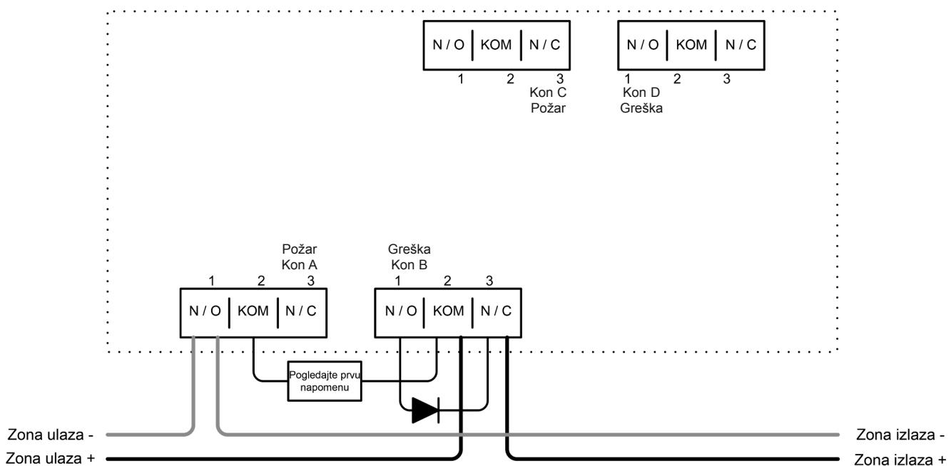
Prva napomena – Ovaj dio je protupožarni otpornik. Otpornik čiju vrijednost propisuje proizvođač upravljačke ploče protupožarnog sustava nije opremljen upravljačem sustava. U instalacijama u SAD-u riječ je obično o kratkospojniku.
