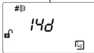
自事件开始过去的时间。如果事件先于最近的循环通电发生，将会显示‘—’。
