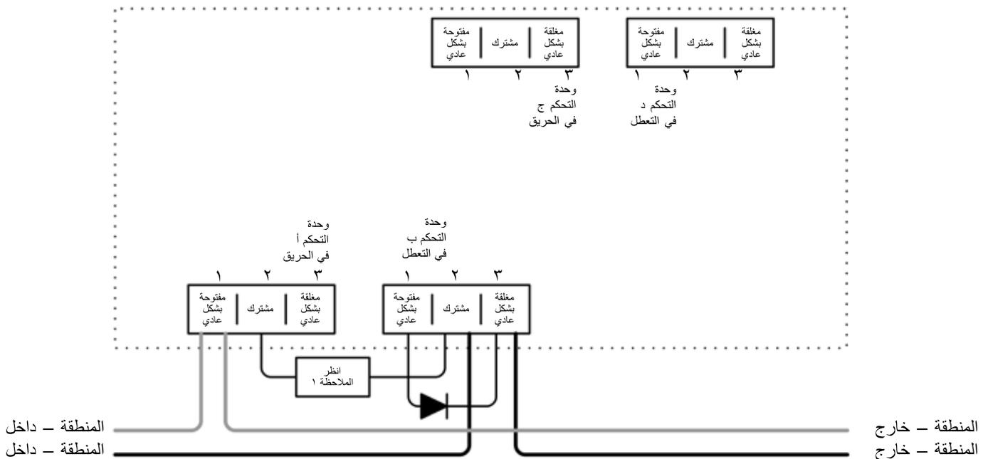
الملاحظة ١ - هذه المكون هو مقاوم الحريق. ويتم تحديد القيمة الخاصة به بواسطة الجهة المصنعة للوحة التحكم في الحريق (FCP)، ولا يتم توفيره برفقة وحدة التحكم في النظام. بالنسبة إلى التركيبات الأمريكية، يمثل عادة دائرة قصر كهربائية.
