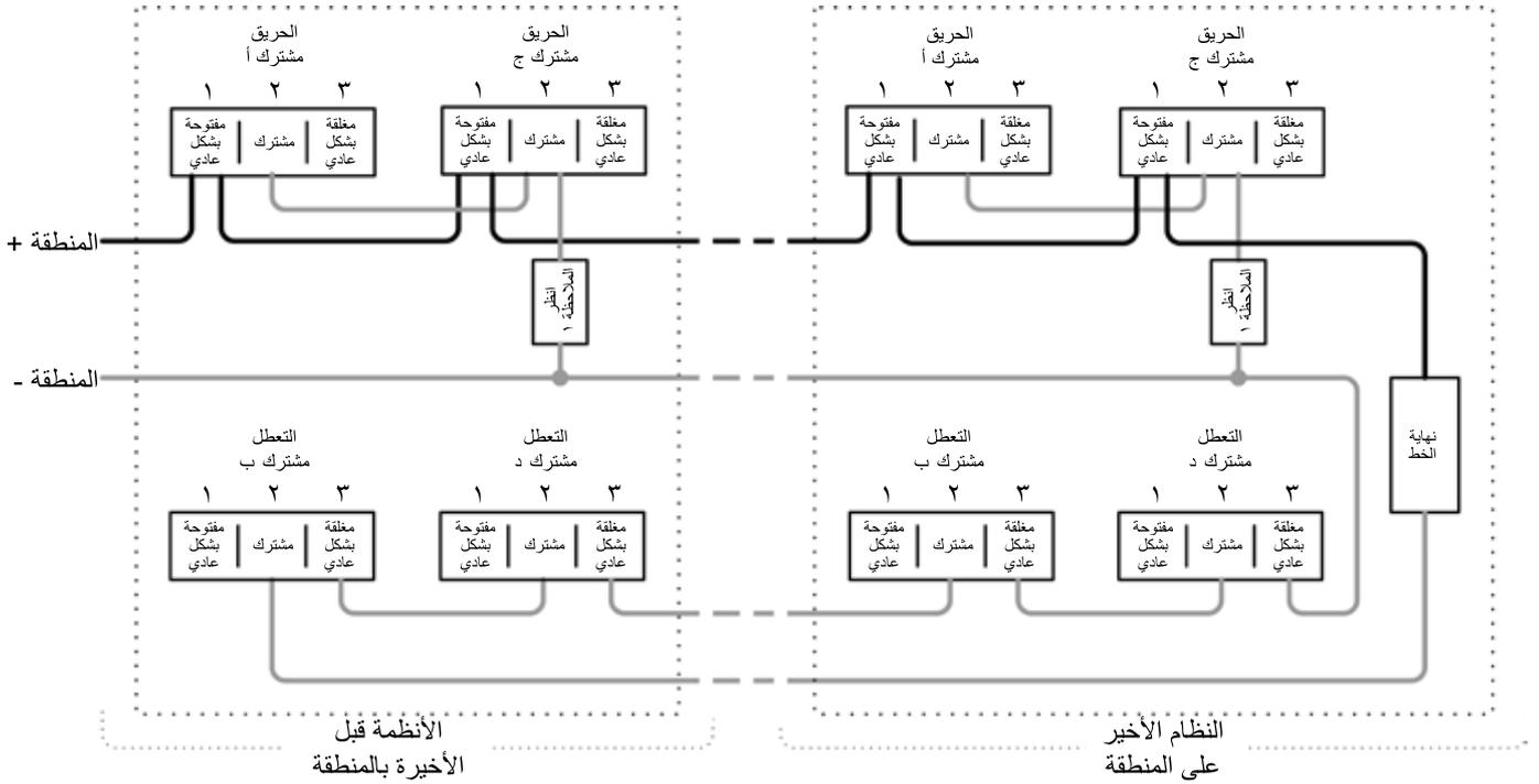
الملاحظة ١ - هذه الجزء هو مقاوم الحريق. ويتم تحديد القيمة الخاصة به بواسطة الجهة المصنعة للوحة التحكم في الحريق (FCP)، ولا يتم توفيره برفقة وحدة التحكم في النظام. بالنسبة إلى التركيبات الأمريكية، يمثل عادة دائرة قصر كهربائية.
