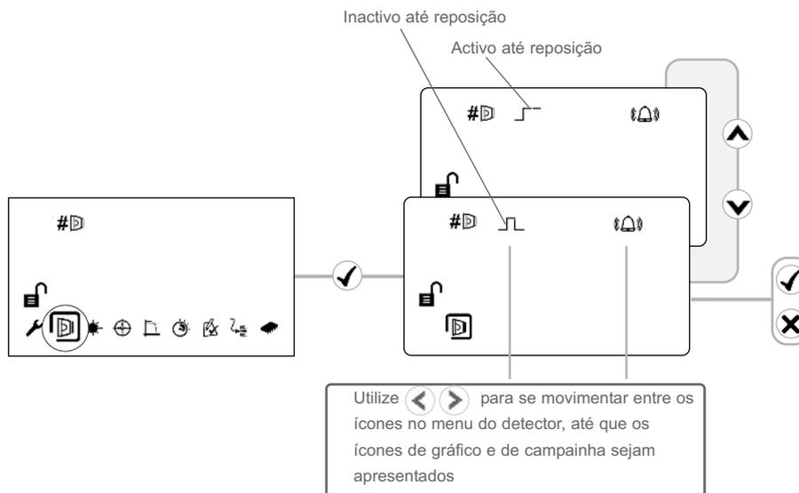
Para eliminar uma condição de sinal activo até reposição, aplique 5-40 V ao terminal de Reposição externa, introduza o código ou reinicie a corrente durante 20 seg.
