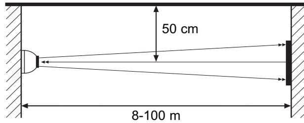
Certificar-se de que existe uma linha desimpedida do detector para o reflector
