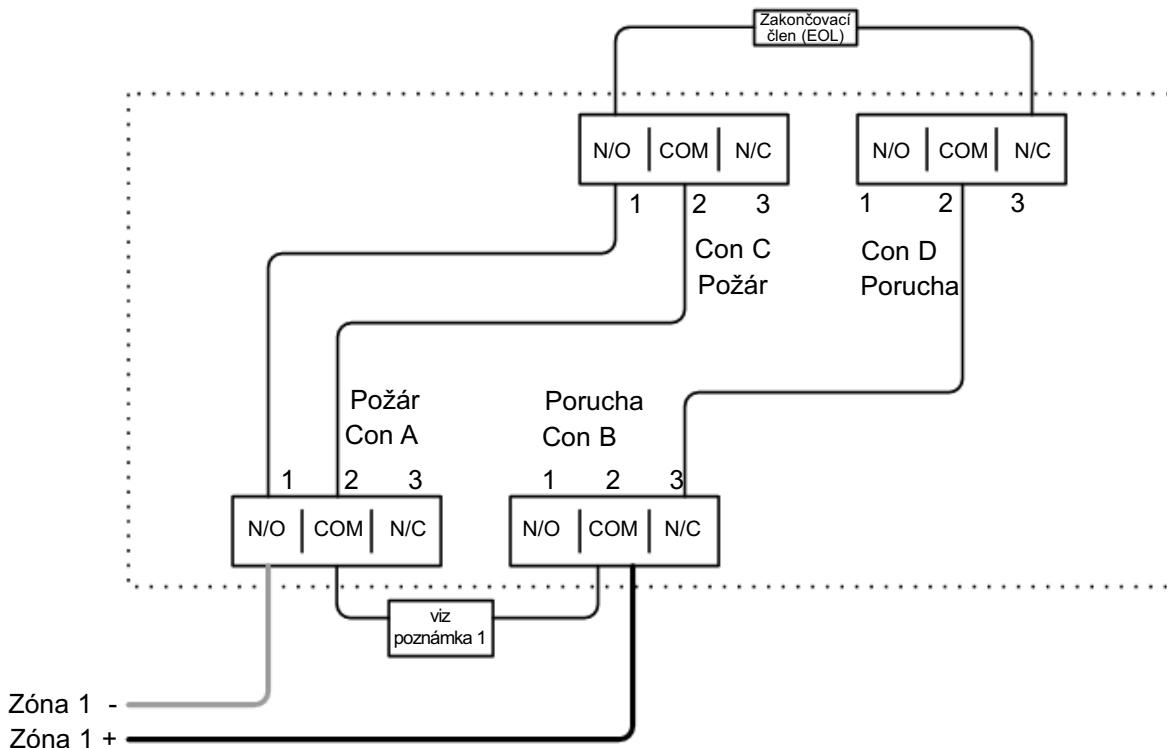
Zapojení k jiným typům požárního řídicího panelu nebo zapojení několika řídicích jednotek do jedné zóny popisují další instalacní pokyny dodané s výrobkem
