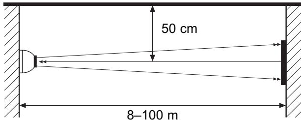
Montáž na pevný povrch (nosná stěna nebo vazník)
