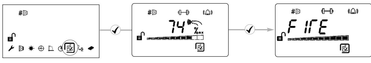
**Zkouška LED kontrolky detektoru Fire (Požár)**
