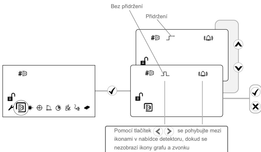
Ke smazání přidrženého požáru přiveděte napětí 5–40 V na svorku External Reset (externí reset), zadejte heslo nebo přerušovaně přivádějte napájení 20 s
